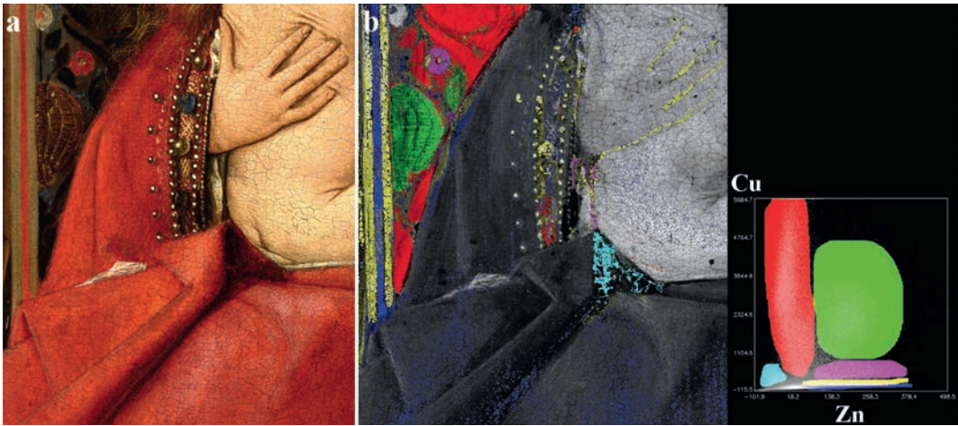
Abb. 6 Detail der Malerei im (a) sichtbaren Licht und (b) MA-XRF-Korrelation der Cu-K- und Zn-K-Signale. Die Korrelations-Kartierung desselben Bereiches zeigt die Präsenz verschiedener zink- und kupferbasierter Pigmente und Additive. // Fig. 6 Detail from the painting in (a) visible light and (b) MA-XRF correlation of the Cu-K and Zn-K signals. The correlation mapping of this area shows the presence of different zinc- and copper-based pigments and additives.
