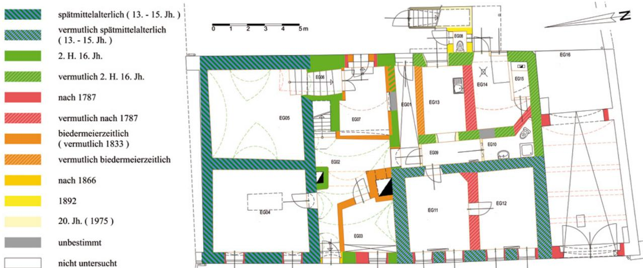
Abb. 43: St. Pölten, Bürgerhaus Lederergasse Nr. 7. Baualterplan des Erdgeschoßes beziehungsweise Souterrains/Kellergeschoßes.
