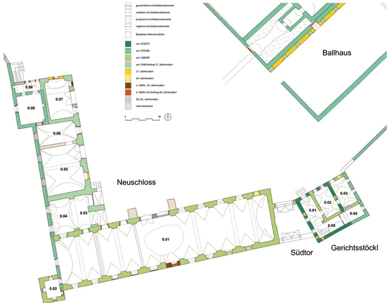
Abb. 44: Schallaburg, Schloss Schallaburg. Baualterplan des Erdgeschoßes (Detailausschnitt Neuschloss und Gerichtsstöckl).
