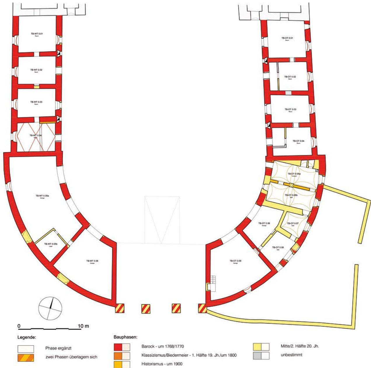
Abb. 3: Losensteinleithen, Schloss Losensteinleithen. Baualterplan.
