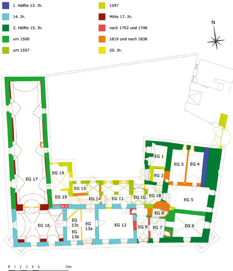
**Abb. 4:** Bruck an der Leitha, Altes Rathaus. Baualterplan des Erdgeschoßes.
