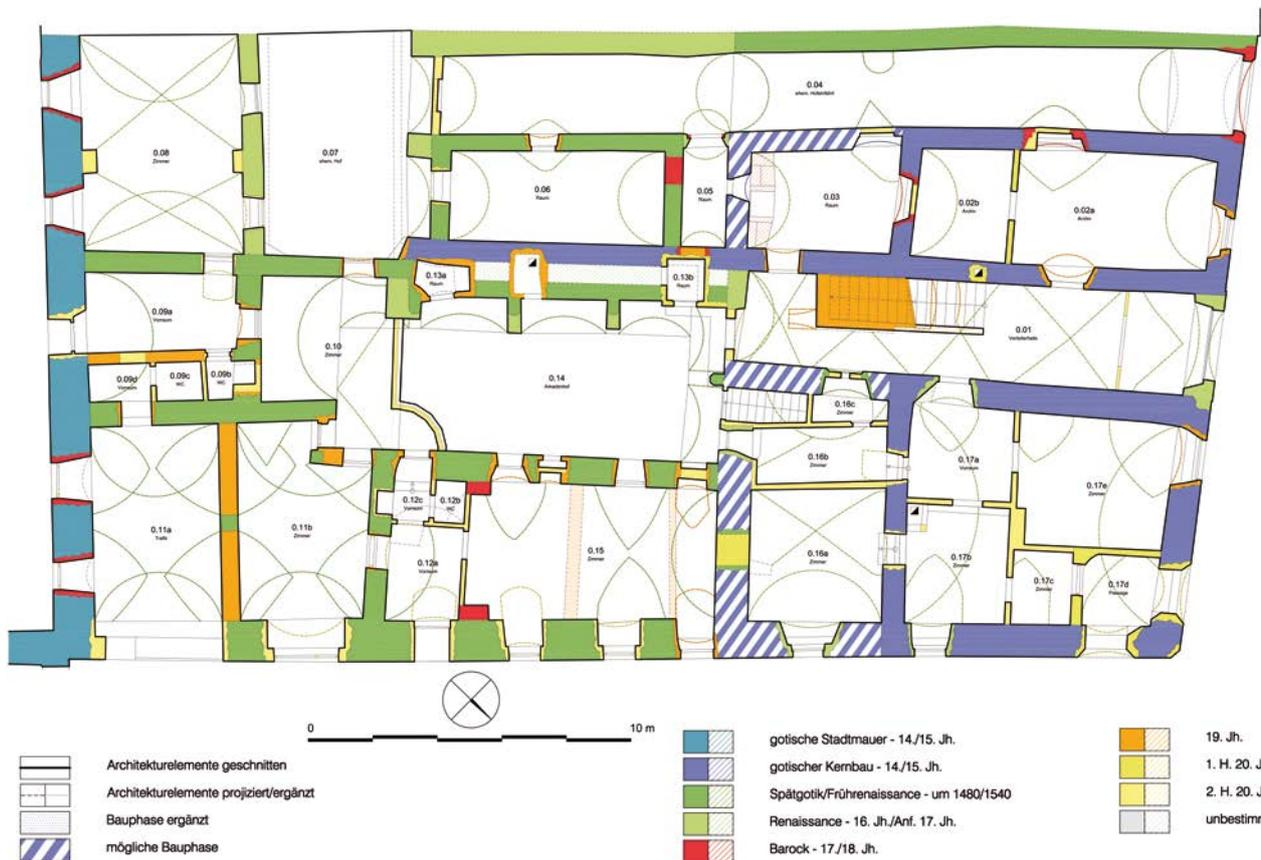
Abb. 47: Waidhofen an der Ybbs, Bezirksgericht. Baualterplan des Erdgeschosses.
