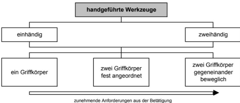
**Bild 1.1:** Benutzung handgeführter Werkzeuge (nach Bullinger et al., 1989)
