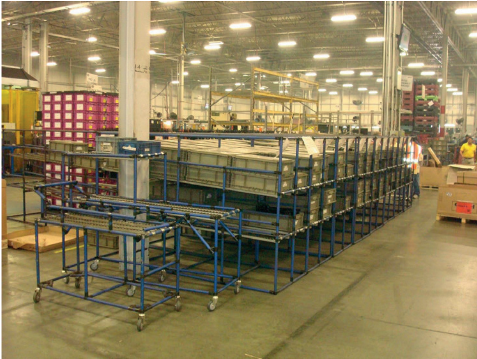
Bild 1.12 Puffer zwischen Vormontage und Endmontage
