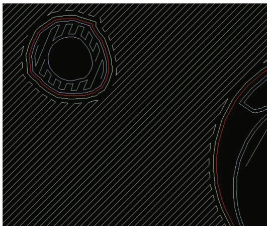
**Bild 1.5** Hier ist die Bahnplanung einer Schicht mit 45°-Schraffur beim Fused Deposition Modeling zu sehen. Es handelt sich um den vollgefüllten Modus mit Fehlstellen im Inneren des Bauteils. Die grünen Linien repräsentieren das Bauteil und die lila Linien das nötige Stützmaterial in der Schicht (© Andreas Fischer 2021).
