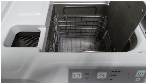
**Bild 1.9** Umwälzungsbehälter des HP Designjet 3D Removal-Systems für die Entfernung von Stützstrukturen bei Fused Deposition Modeling-Bauteilen aus Acrylnitril-Butadien-Styrol mit maximalen Abmaßen von 200 × 200 × 150 mm (© Andreas Fischer 2021)
