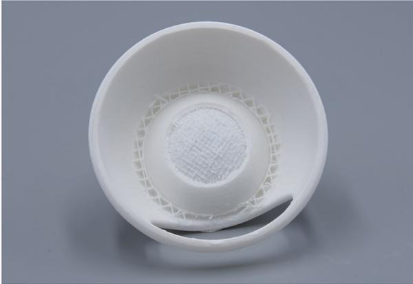
**Bild 1.12** Aus Acrylnitril-Butadien-Styrol und mittels Fused Layer Modelings gefertigter Eierbecher mit defekter lokaler Oberfläche, hervorgerufen durch die mechanische Entfernung des Stützmaterials (© Andreas Fischer 2022)
