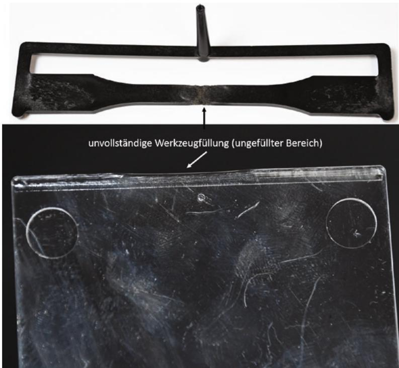
**Bild 1.19** Unvollständige Werkzeugfüllung
