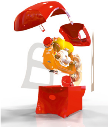
Bild 2.1 CAD-Modelle enthalten technische Formen mit exakten Maßen und Zusammenhängen (© Siemens PLM Software; Zumex „Soul“ designed in Solid Edge).
