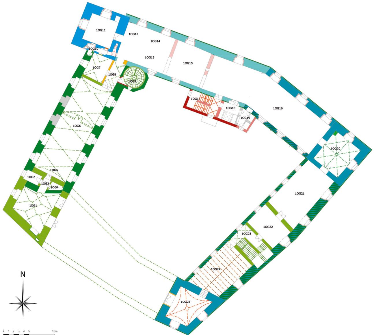
Abb. 21 Orth an der Donau, Schloss. Bauphasenplan des 1. Obergeschoßes.
