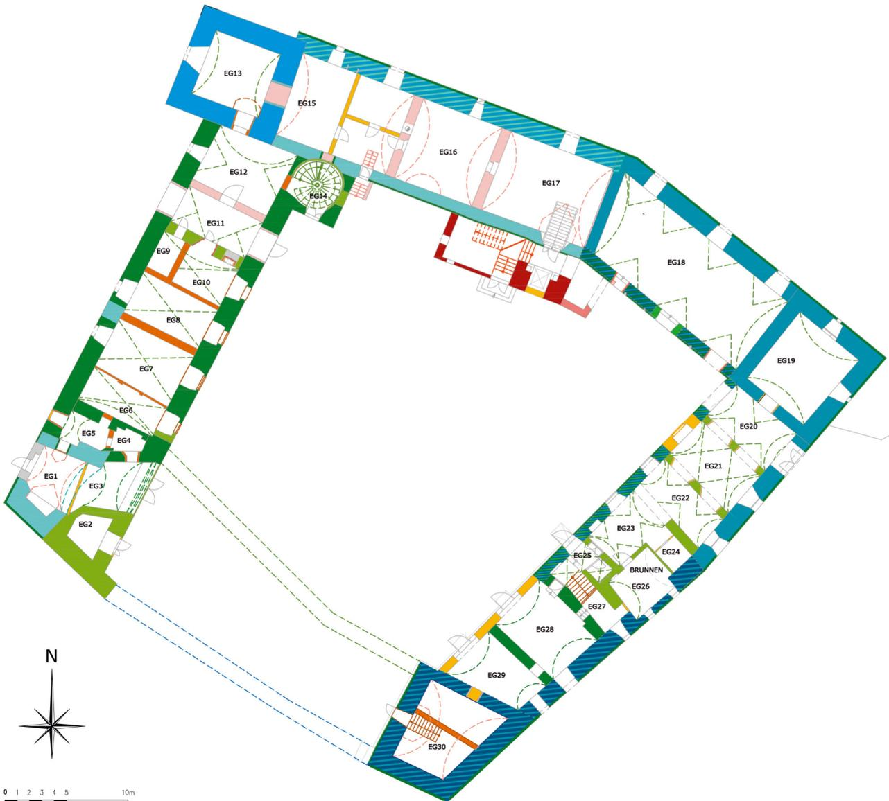
Abb. 20 Orth an der Donau, Schloss. Bauphasenplan des Erdgeschoßes.
