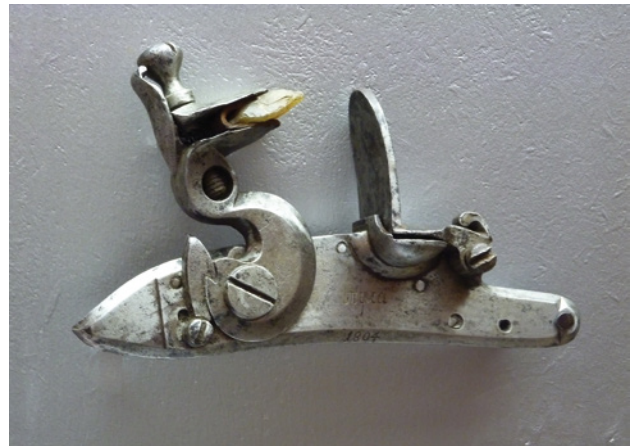
Abb. 89: Steinschlossmechanismus in Sicherheitsrast.
