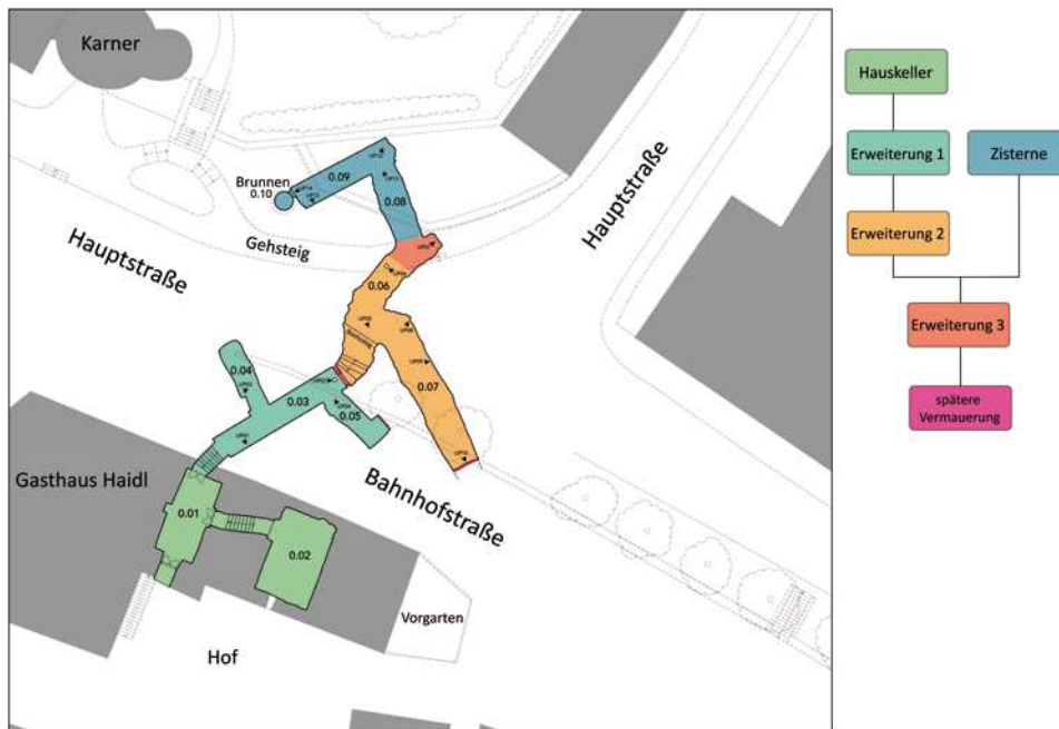
Abb. 34: Thaya, Haidlkeller. Baualterplan der Keller- und Zisternenanlage.
