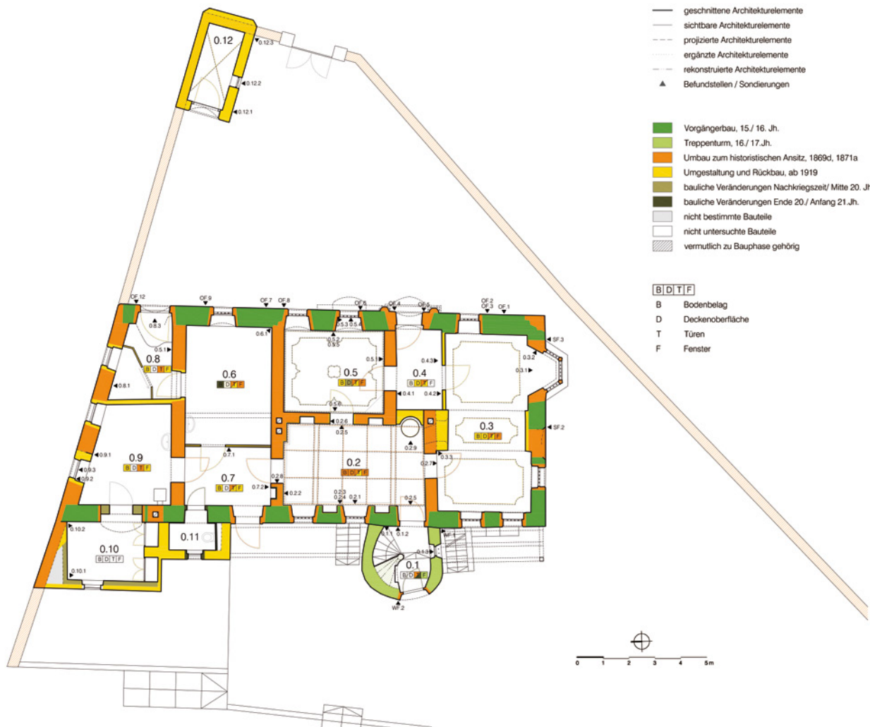
Abb. 12: Schwarz, Minkus-Schlössl. Baualterplan des Erdgeschoßes.
