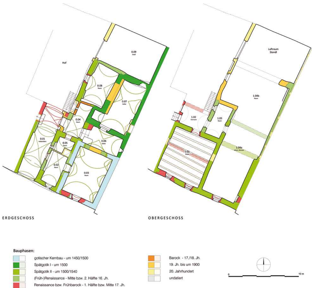
Abb. 4: Bruck an der Leitha, Bürgerhaus Burgenlandstraße Nr. 7. Baualterplan des Erd- und des Obergeschoßes.
