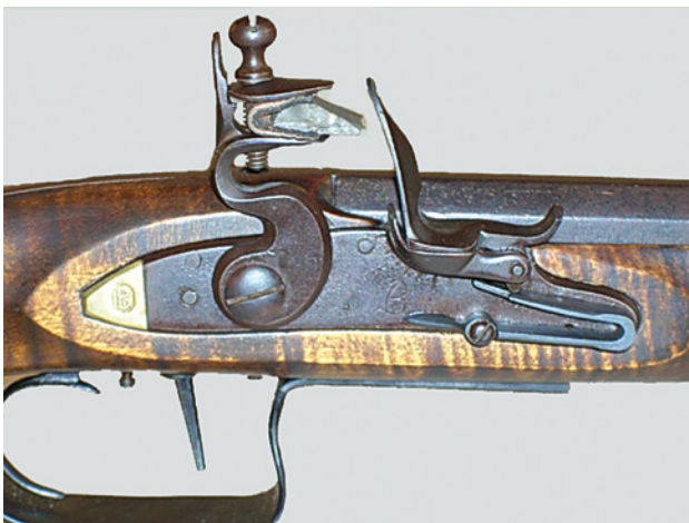
Abb. 88: Steinschloss mit eingespanntem Feuerstein.
