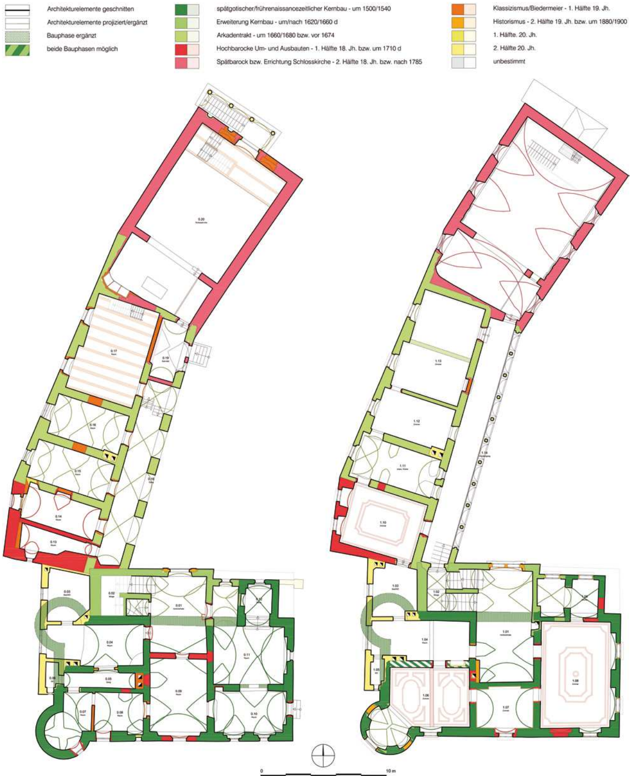
Abb. 2: Eggendorf, Schloss. Bualterplan des Erdgeschoßes (links) und des 1. Obergeschoßes (rechts).
