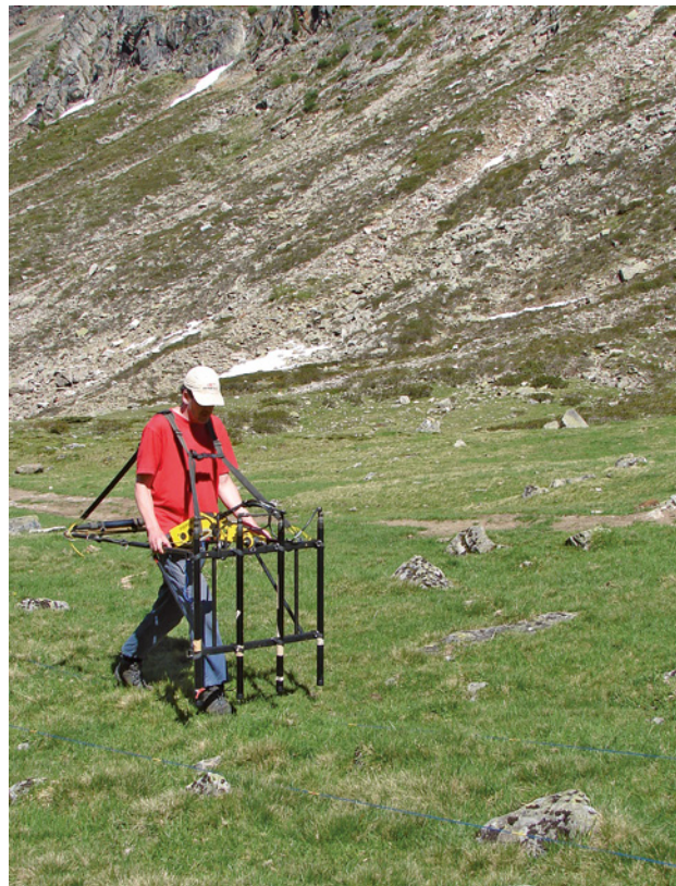
Abb. 98: Kühltai. Messung mit dem Fluxgatemagnetometer auf dem Areal »Obere Längentalalm«.
