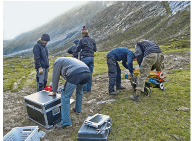
Abb. 108: Kühtai. Träger mit dem Laserscanner und Zubehör. Da die Vorarbeiten schon während der Lehrveranstaltungsvermessungen erfolgten, konnten die Scans innerhalb von vier Messtagen ohne nennenswerte Probleme abgewickelt werden.
