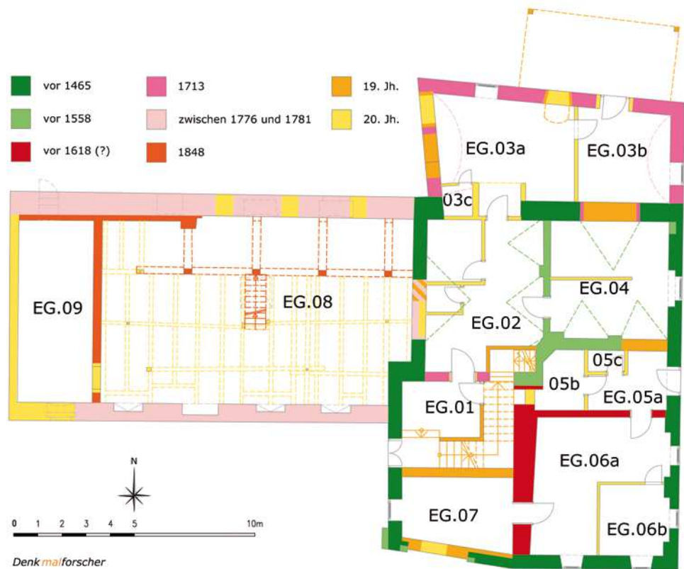
Abb. 23: Mödling, Putschermühle. Baualterplan des Erdgeschoßes.
