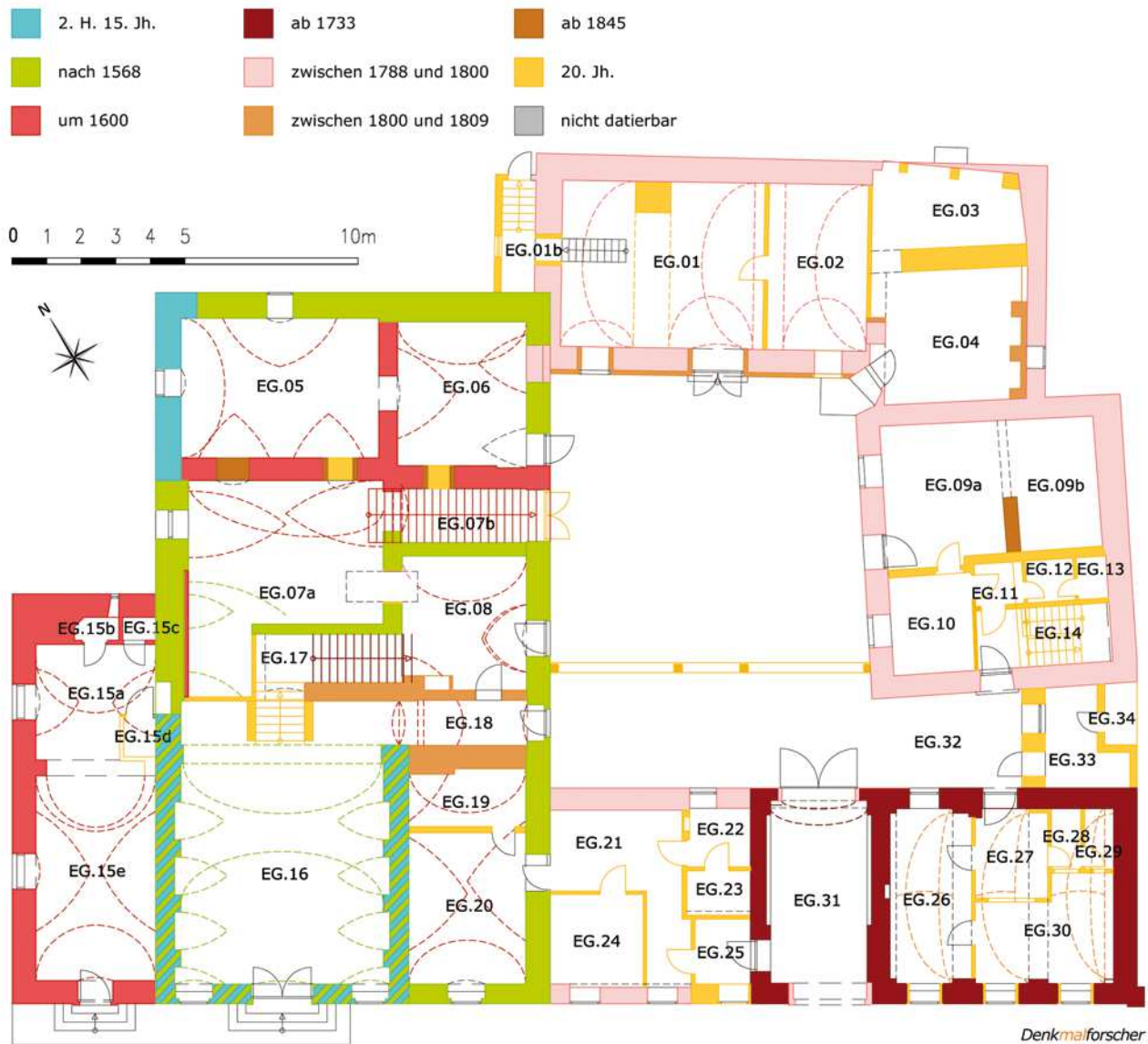
Abb. 26: Persenbeug, Rathaus. Baualterplan des Erdgeschoßes.
