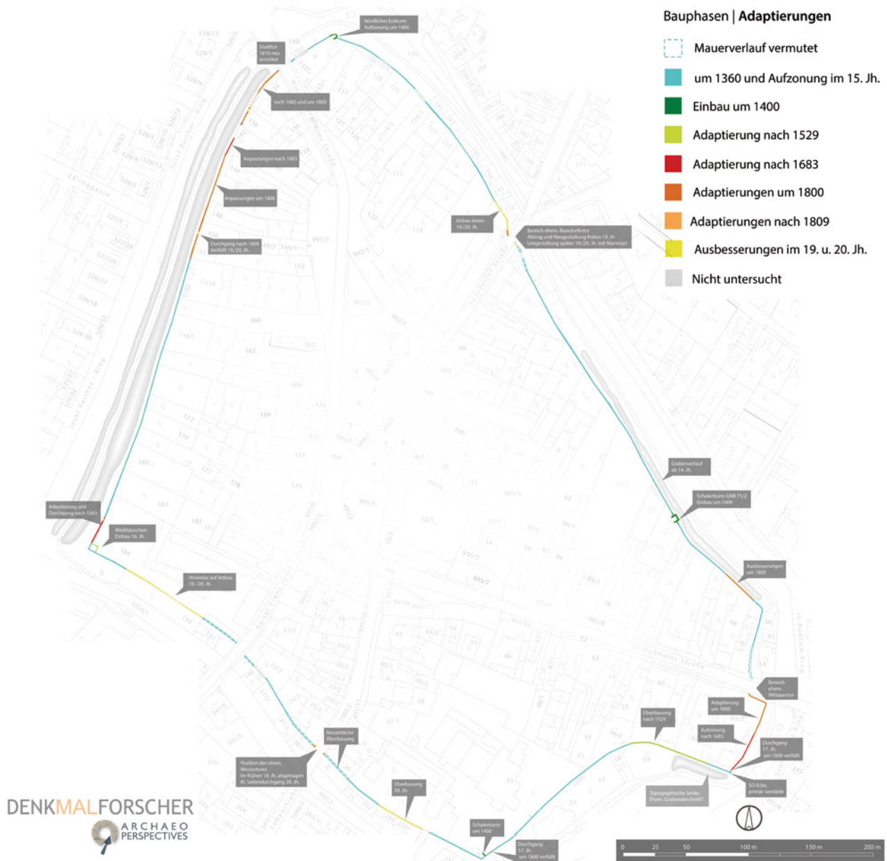
Abb. 10: Großenzersdorf, Stadtbefestigung. Bualterplan der Befestigungsanlagen.
