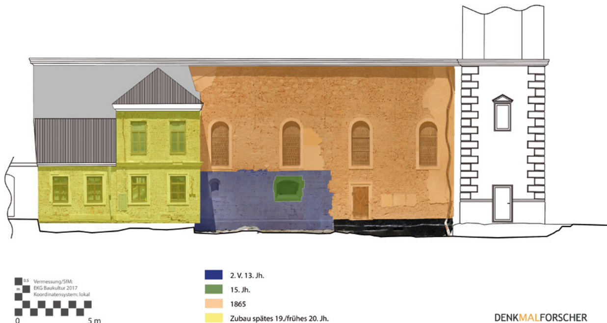
Abb. 30: Schwarzau am Steinfeld, Pfarrkirche. Bauphasen der Südfassade.
