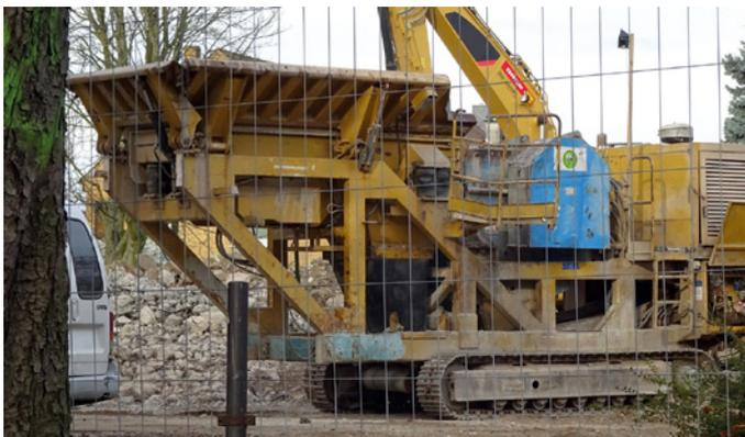
**Bild 1.16** Recyclinganlage für Baustellen
