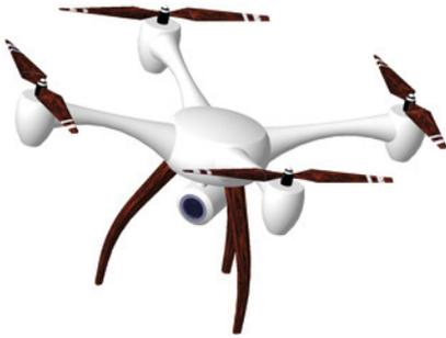
**Bild 1.29** 3D-CAD-Modell einer Drohne, erstellt mit Creo Parametrics [1.9]
