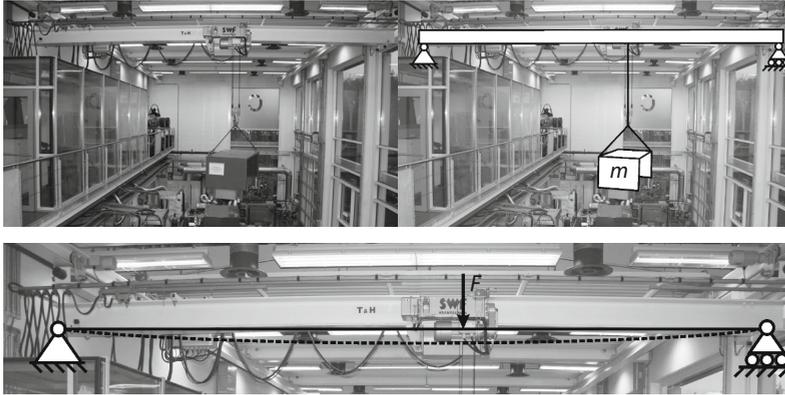
**Bild 3.18** Hallenkran der Universität Bayreuth (links oben); erste schematische Vereinfachung des Realmodells (rechts oben); technische Darstellung des Biegebalkens mit Biegelinie (unten)
