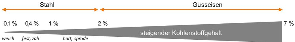
**Bild 2.9** Eigenschaften der Eisenwerkstoffe in Abhängigkeit vom Kohlenstoffgehalt
